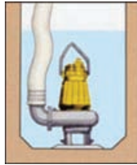
شکل ۸-۵- نصب پمپ کف کش در چاهک
