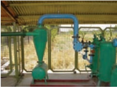
شکل ۲۷-۶- نحوه کار سیکلون و شکل ظاهری آن
